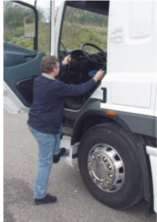
Verteilergerecht: Dank gut gestuften Einstieg geht es bequem und sicher in die Kabine.
