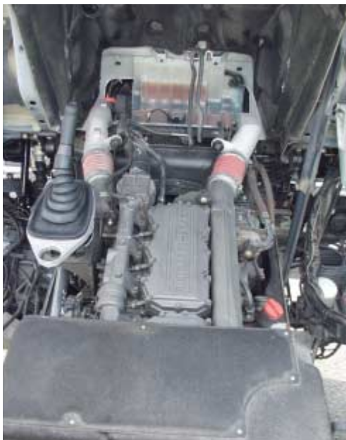
Durchzugsvermögen: Der 310 PS starke 9,2-l-DAF-Hightech-Diesel gibt das maximale Drehmoment von 1.275 Nm zwischen 1.100 und 1.700/min ab.
