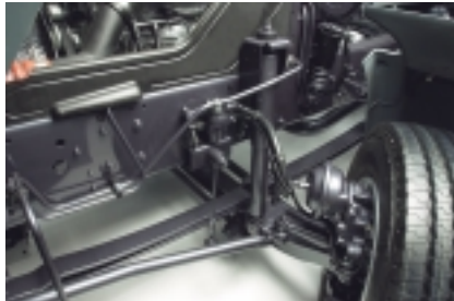
Die neue Vorderachse mit einem Einschlagwinkel von etwa 52° sorgt für eine hohe Wendigkeit der LF-Modelle.
