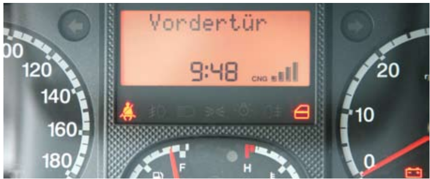
Eine zusätzliche Anzeige im Zentralsdisplay mit vier Säulen zeigt den Füllstand des Erdgasvorrats an.
