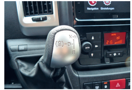
Der Wählhebel für Fahrtrichtung und Rekuperation hat bereits eine lange Vergangenheit im Ducato.
