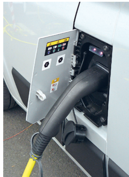
Strom gezapft wird unten an der B-Säule, die Ladeleistung ist eher mau.
