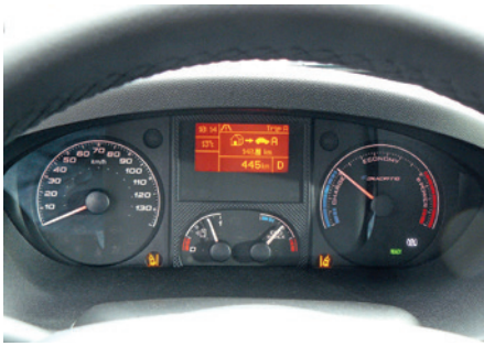
Das Powermeter rechts zeigt die aktuell abgeforderte Leistung und die Rekuperation.
