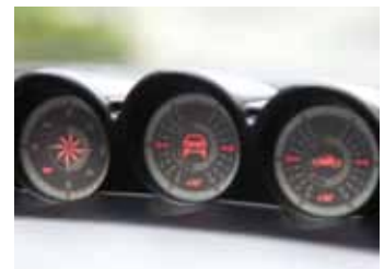
Ich wäre so gerne ein Offroader: Kompassrose und Neigungsmesser als Zusatzinstrumente der gehobenen Ausführungen
