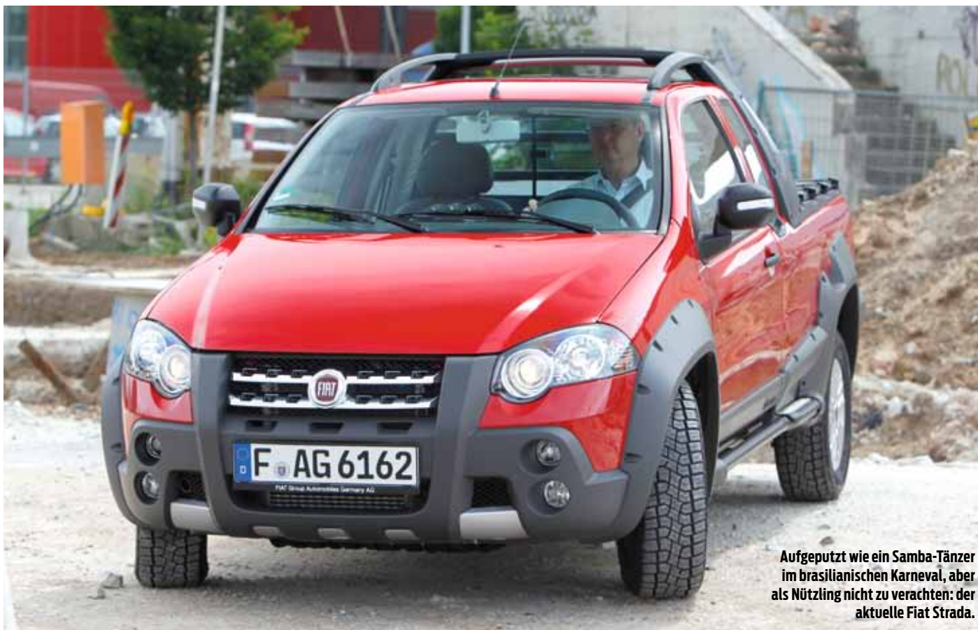
Die Pritsche misst rund 2,5 Quadratmeter, schultern darf der Strada mehr als eine halbe Tonne.
