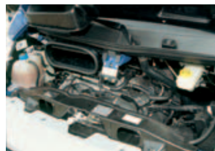
Ein Prachtstück von einem Motor: Dreiliter-Maschine mit 157 PS und 400 Nm Drehmoment. Doch auch die anderen Motoren haben Mumm.
