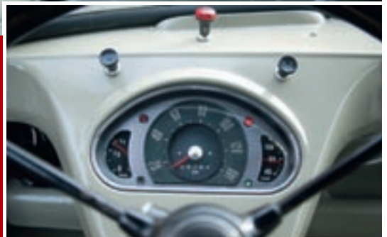
(oben) Ein Arbeitsplatz von gestern: Nacktes Blech umgibt den Fahrer, der Motor fährt als Beifahrer in der Kabine mit. (unten) Die Instrumente vermitteln nur Basiswissen. Immerhin reicht der Tacho optimistisch bis Tempo 140 – besser nicht probieren. Zugschalter für Licht und Wischer
