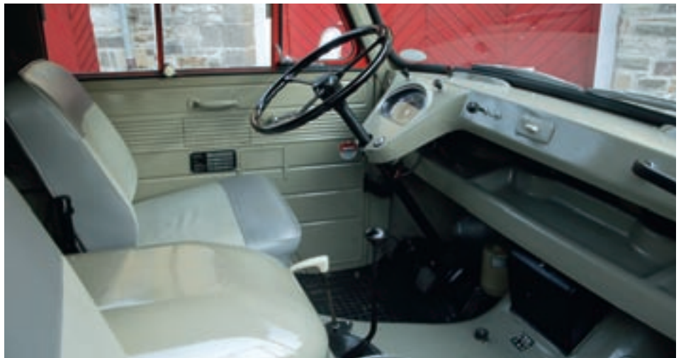
(oben) Ein Arbeitsplatz von gestern: Nacktes Blech umgibt den Fahrer, der Motor fährt als Beifahrer in der Kabine mit. (unten) Die Instrumente vermitteln nur Basiswissen. Immerhin reicht der Tacho optimistisch bis Tempo 140 – besser nicht probieren. Zugschalter für Licht und Wischer
