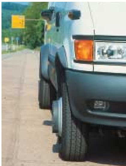
Die Vorderachse steht hoch, markant sind Kotflügelverbreiterungen und der herausstehende Wulst für die Schiebetür – allemal billiger als eine neue Karosserie.
