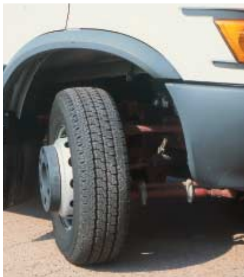
Vorn gibt's unverändert eine Einzelradaufhängung, auch 16-Zoll-Räder hat der Daily von Hause aus. Neue Zutaten sind Breitreifen und verstärkte Federn.
