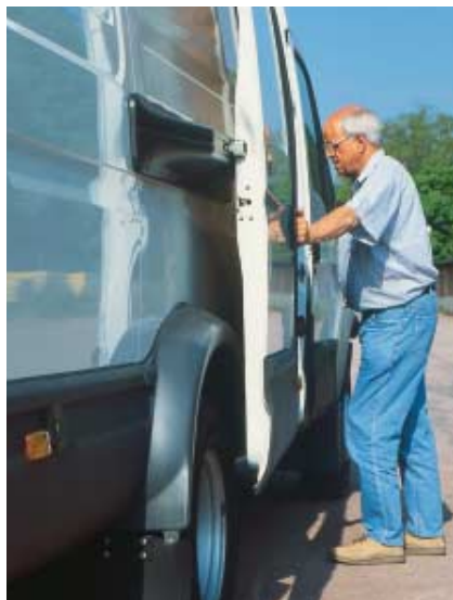
Dank der ungewöhnlichen Führung gleitet die Schiebetür sicher an der breiten LKW-Hinterachse und den Kotflügelverbreiterungen vorbei.
