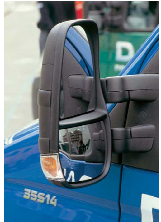
Große Außenspiegel mit üppigen verstellbaren Weitwinkelgläsern in der unteren Hälfte.
