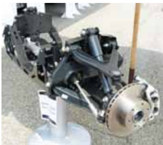
Für die schweren Daily ab 5,2 Tonnen Gesamtgewicht: neue Doppelquerlenkerachse mit Drehstabfedern.
