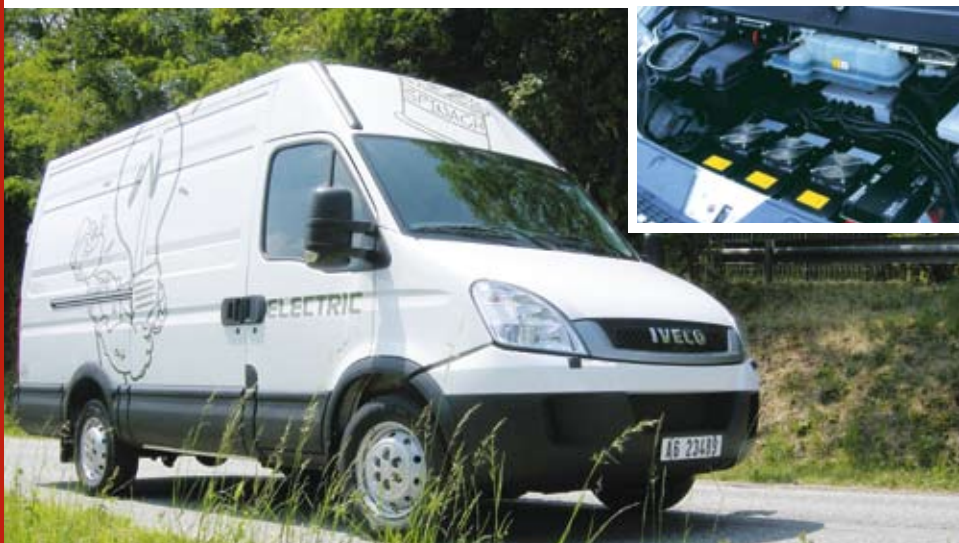
Der erste große Elektro-Transporter, der serienmäßig in Fertigung ist: Iveco Daily mit E-Antrieb und überraschend großer Reichweite. Unter der einstigen Motorhaube des E-Daily steckt jeweils ein Ladegerät pro Batterie.
