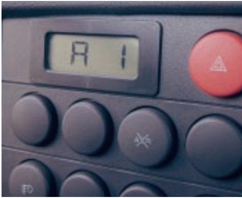
Das Display gibt warnende Hinweise, sagt freundlich OK und zeigt auch im Automatikbetrieb den eingelegten Gang.
