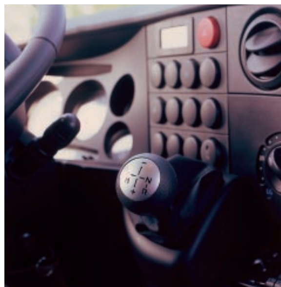
Ragt der Daily-Schaltstock aus dem Boden, so wächst der kugelige Schaltknauf des Agile-Joysticks aus dem Armaturenbrett heraus.
