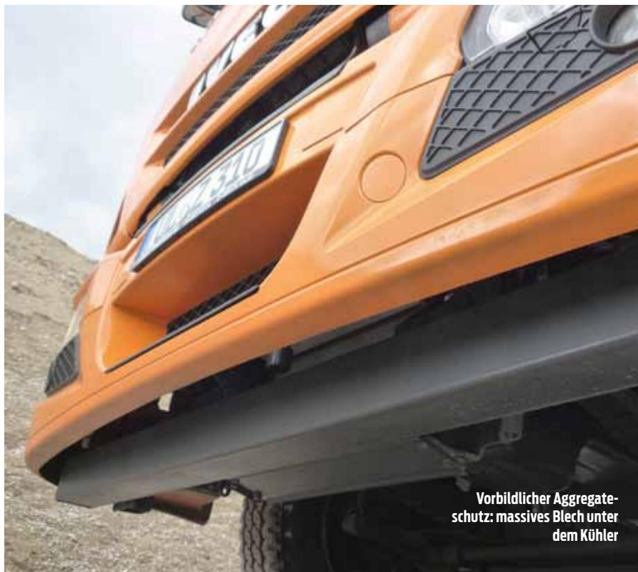
**Vorbildlicher Aggregatenschutz: massives Blech unter dem Kühler**
