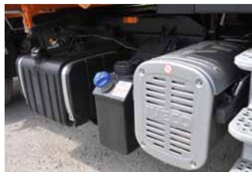
Abgasreinigung mit SCR-Katalysator und Additiv Adblue
