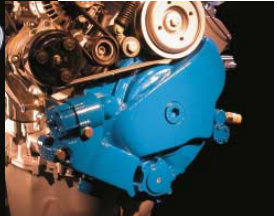
Der Pritarder von MAN oder Aquatarde, wie ihn sein Hersteller Voith vermarktet, ist eine hydrodynamische Bremse, die im Gegensatz zu herkömmlichen Retardern direkt mit der Wasserpumpe in den Kühlkreislauf des Motors integriert ist.
