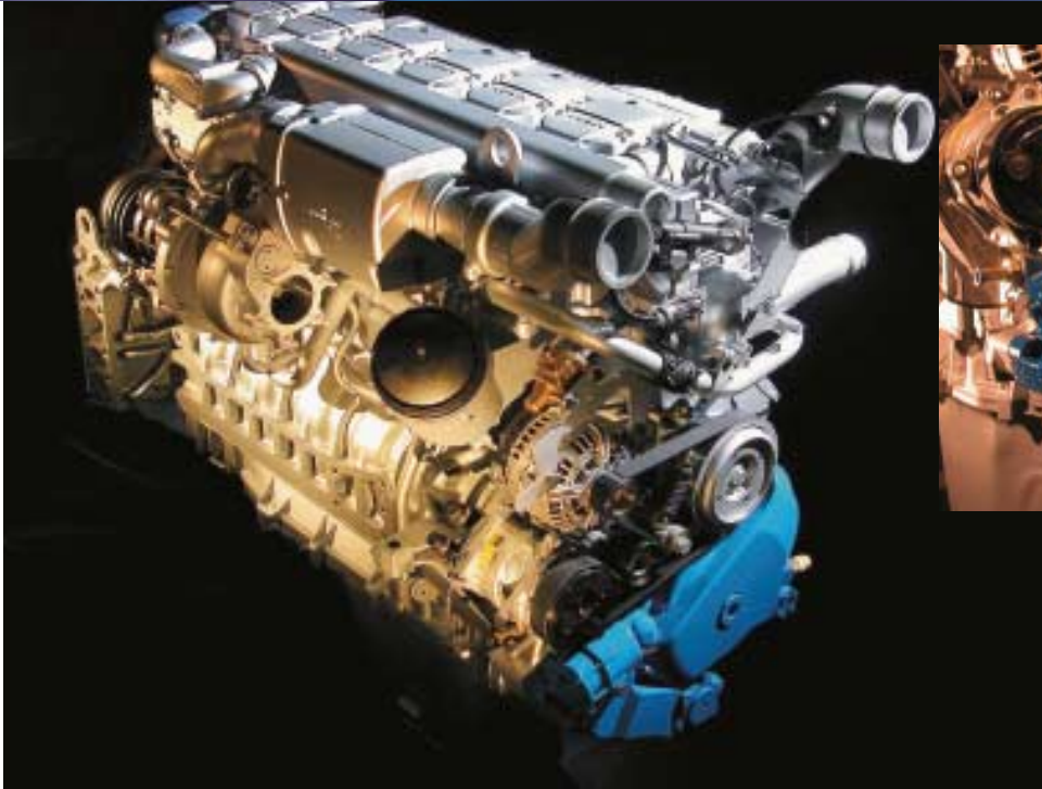
Der Pritarder von MAN oder Aquatarde, wie ihn sein Hersteller Voith vermarktet, ist eine hydrodynamische Bremse, die im Gegensatz zu herkömmlichen Retardern direkt mit der Wasserpumpe in den Kühlkreislauf des Motors integriert ist.
