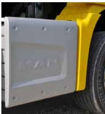
**Kompakte Auspuffanlage: Im Schalldämpfer werden Oxikat, SCR-Katalysator und der Partikelfilter integriert.**
