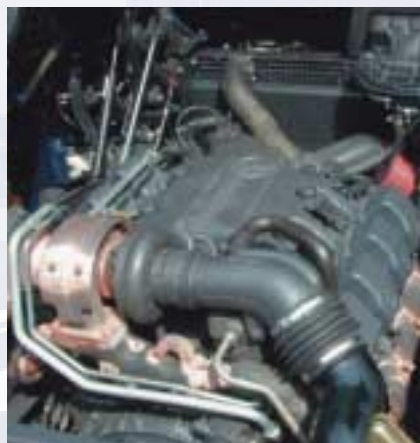
Kompakt: der 428 PS starke 12-l-V6-Diesel im Actros 1843
