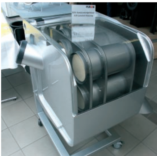
Der SCR-Katalysator ist in den Auspufftopf integriert.
