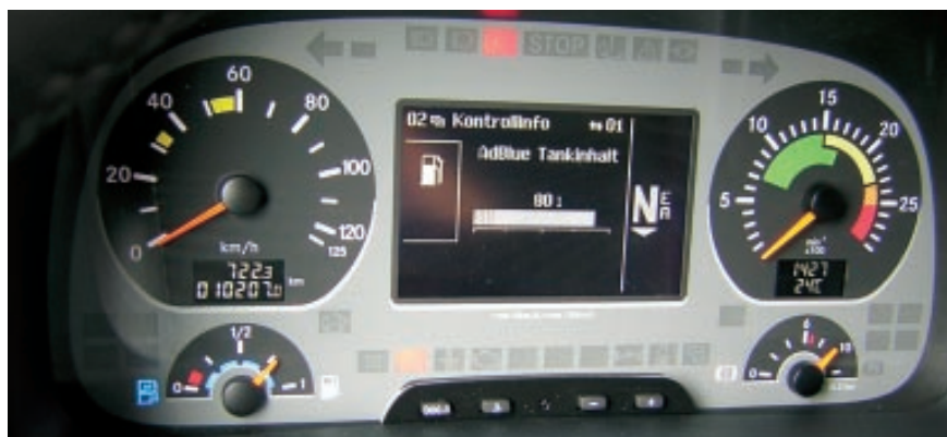
Die analoge Ad-Blue-Tankuhr und die litergenaue Abfrage über das Fahrer-Informationssystem ergeben eine doppelte Sicherheit.
