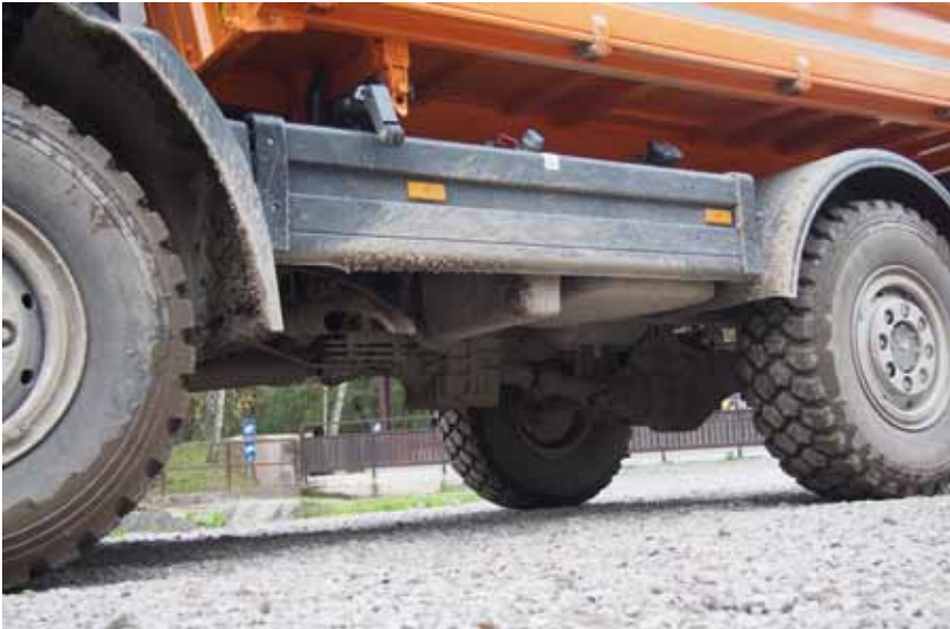
Die großformatige Einzelbereifung schafft Platz unter dem Großserien-Fahrgestell.
