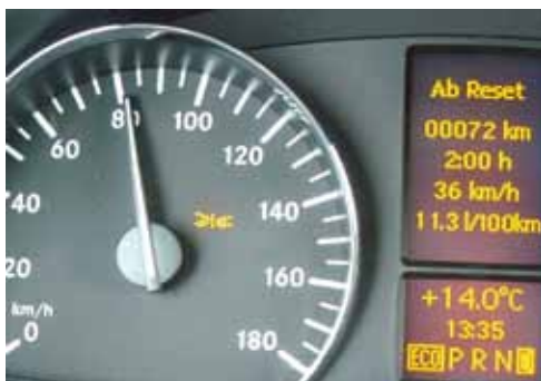
Bitte nicht drängeln: Bei zu geringem Abstand leuchtet die Warnlampe des neuen Abstands-Warnassistenten auf.
