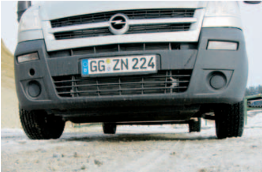
Keine Gefahr bei Bodenkontakt – ein stabiles Schutzblech schützt Ölwanne und Kühler.
