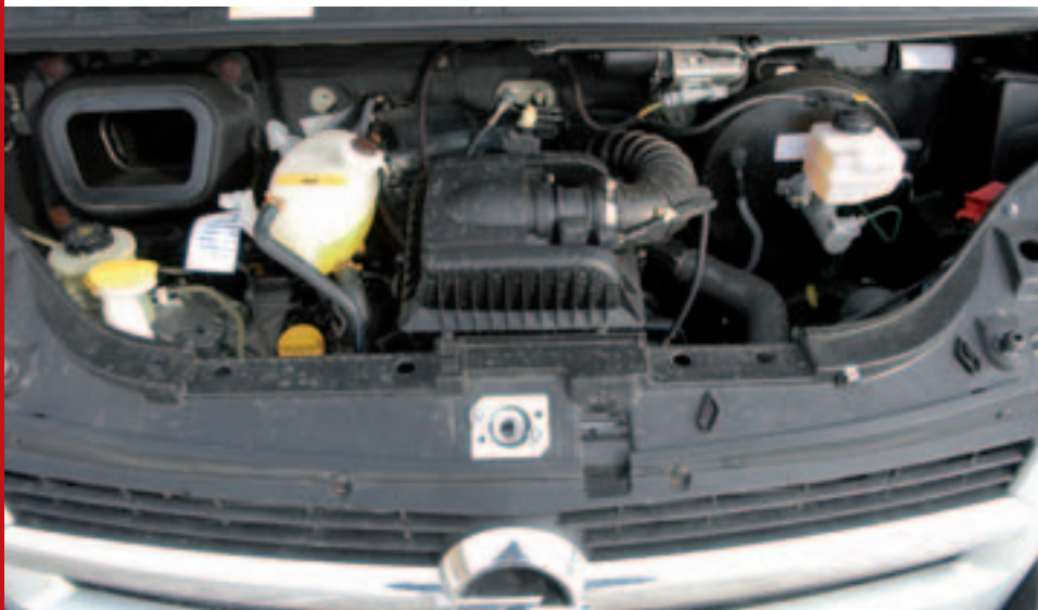
Quicklebendig und vorlaut: DTCI-Vierzylinder mit 2,5 l Hubraum, leistungsstark mit 146 PS
