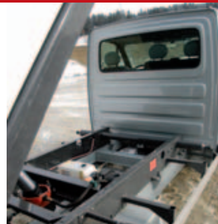
Der mächtige Hilfsrahmen verstärkt das Movano-Fahrgestell – die Hydraulikpumpe sitzt im Rahmen.
