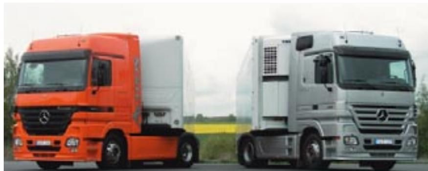
**Spart Diesel: Der Bridgestone GMD senkte beim Testfahrzeug Actros 1846 LS 4x2 (rechts) den Durchschnittsverbrauch um 1,0 l/100 km.**
