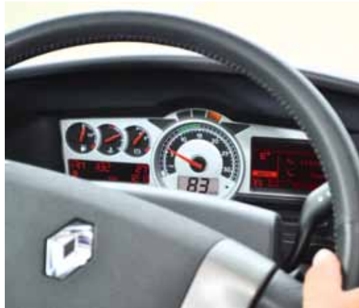
Kontrollierter Freilauf: Bei aktiviertem Tempomat und abfallender Topographie rollt der Magnum im Neutralgang.
