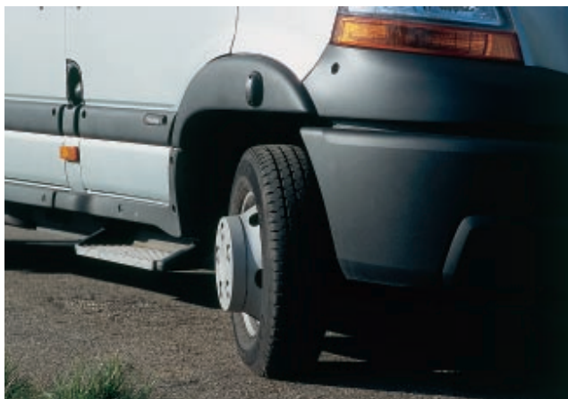
(oben) Eigenwillige Optik: Blenden an den Radläufen, dahinter eine starre Vorderachse, Gitterrost als Trittstufe (unten) Zwillingsbereifung an der Hinterachse, die seitlich aus der Karosserie heraussteht
