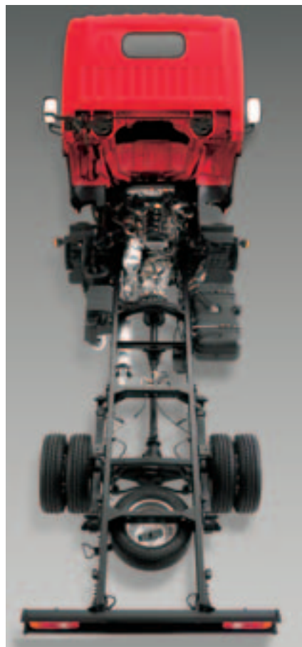
Der Maxity besitzt als Leicht-LKW ein kippbares Fahrerhaus und einen aufbaufreundlichen Leiterahmen.
