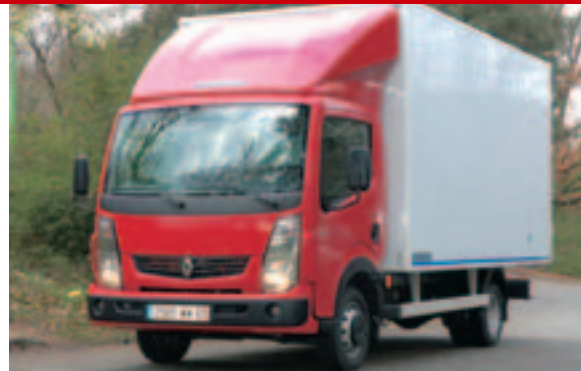
Der 150 PS starke Maxity 150.45/6 brachte die Leistung auf der Probefahrt mit leerem Kofferaufbau mit großem Schlupf auf die Straße.
