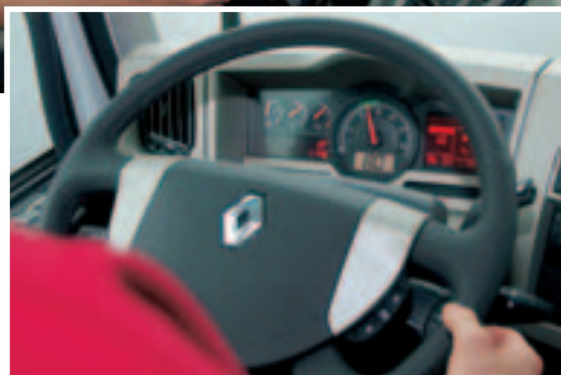
Zwei in eins: Der analoge Drehzahlmesser mit integrierter digitaler Geschwindigkeitsanzeige ist das Besondere bei Renault Trucks.
