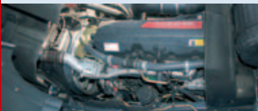
Kompakt geraten: Für seine Hubraumklasse besitzt der 10,8-l-Motor DXi11 eine durchzugsstarke Charakteristik.
