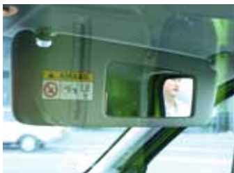
Verblüffende Idee: Der Rasierspiegel in Übergröße für den Beifahrer ist eigentlich ein zusätzlicher Außenspiegel.
