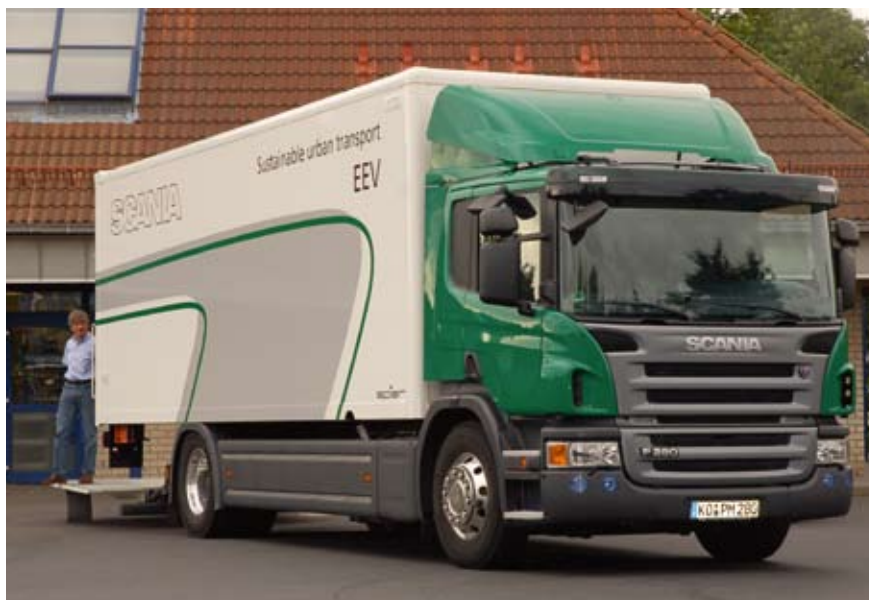
Das Testfahrzeug bringt leer mit vollem Tank, Aufbau und Ladebordwand etwa 9,2 t auf die Waage.
