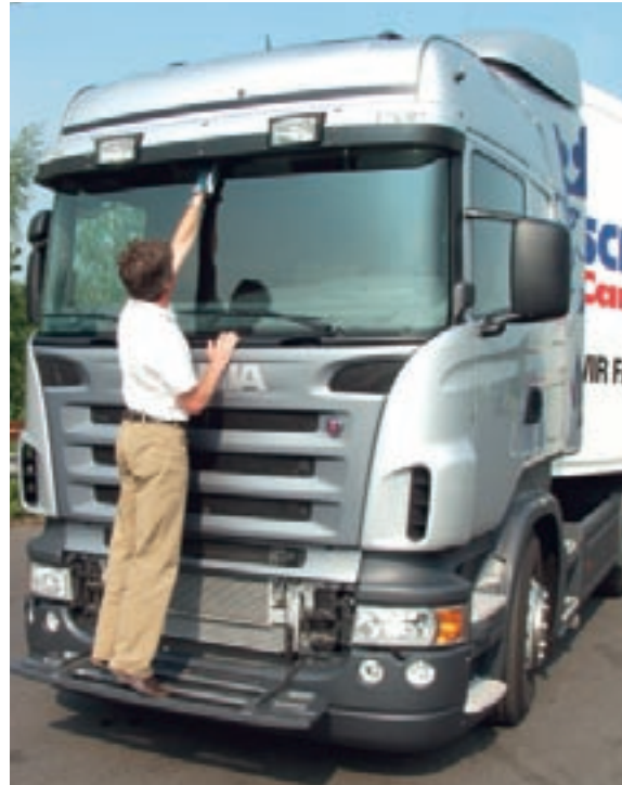
Auch bei der Baureihe R sorgt ein großzügiger Klapptritt für die Sicherheit des Fahrers.
