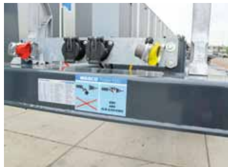
Vordere Kupplungsleiste: nur noch ISO 12098
