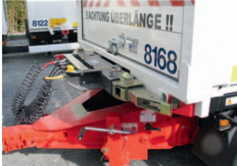
WAB auf Containerchassis: vorderer Tragarm ungeeignet
