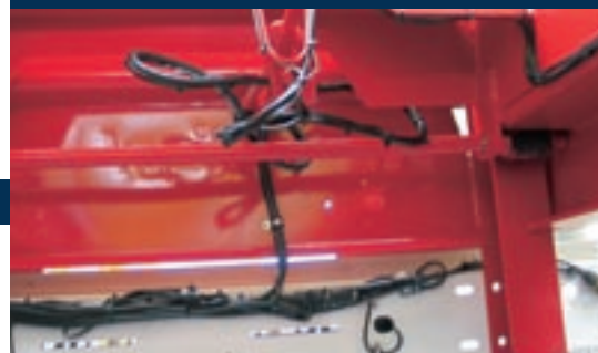
Die Kabelführung – Ausschub eingefahren
