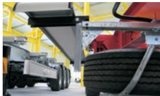
Knapp über dem Reserverad: der geklappte Anfahrerschutz
