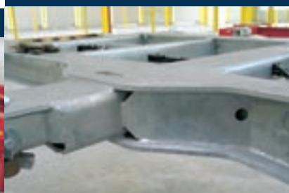
Materialverstärkung am vorderen 20-ft-Tragarm
