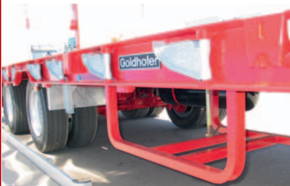
Anfahrerschutz abgebaut: Zugang zum Reserveradhalter
