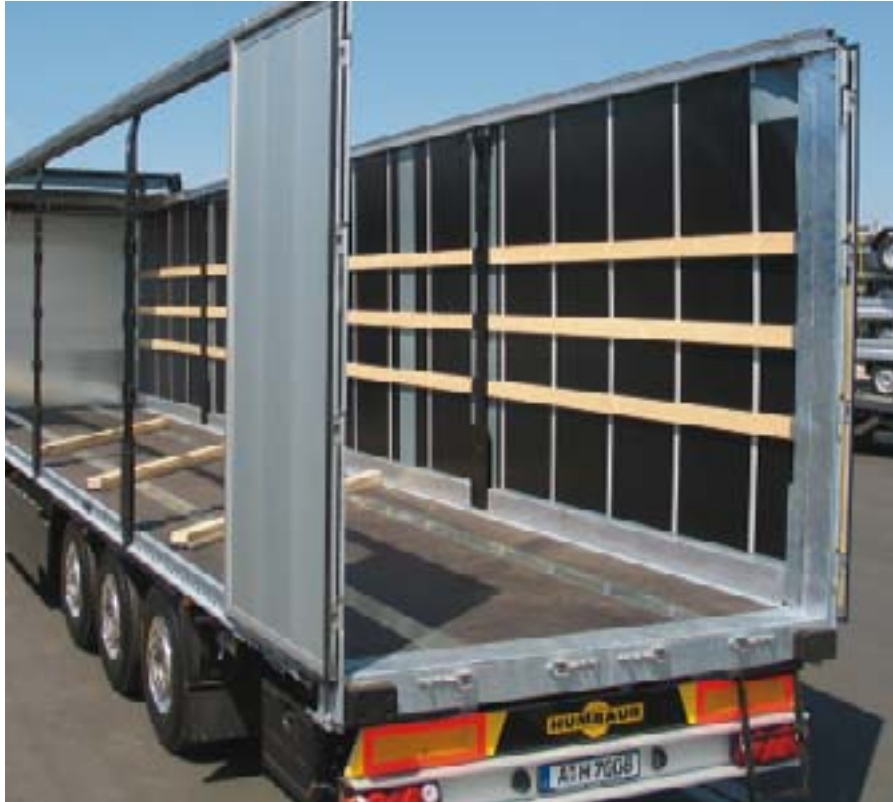
Zur Verstärkung: Rohrquerträger im Heck
