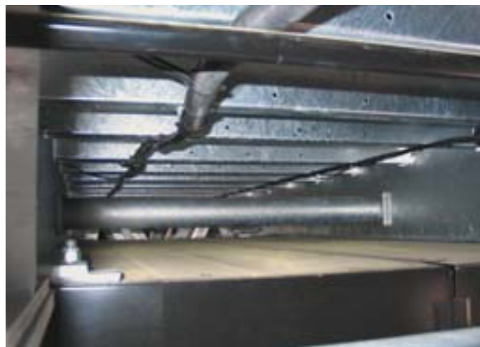
Zur Verstärkung vorn: Rohrquerträger
