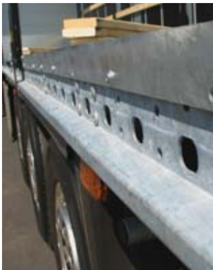
Gelochter Außenrahmen und geschraubte Palettenstoßkante
