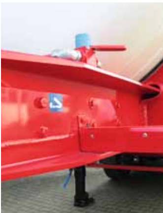
Kässbohrer-Chassis-Merkmal Extrusions-Längsträger einteilig
