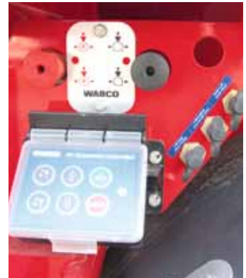
Schaltventile und Prüfanschlüsse
