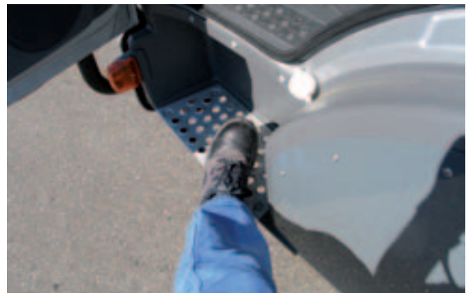
Atego-Kabine als Lowdeck und Eisabweiser auf dem Dach. Beim Actros besser: glatter Rand der Einstiegsstufe beim Atego.
