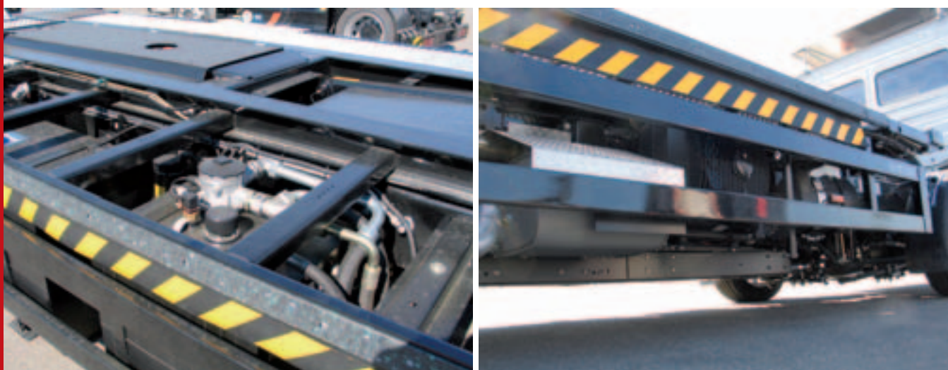
Links Dieseltank, Hydrauliktank, Motor unter der Abdeckung. Rechts Luftfilter, Kühler, Auspuffanlage
