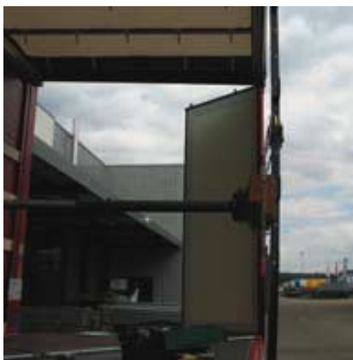
Durchbiegung bei Druck in 80 cm Höhe
