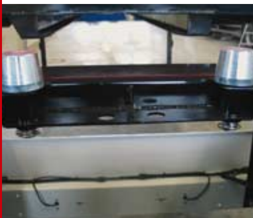
Zentrierrollen nach vorn verlegt
