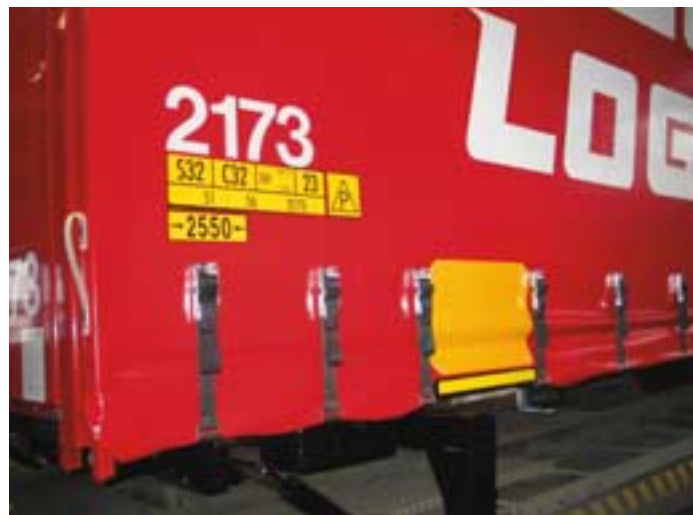
Aramidplatte statt Klappblech gegen die Greiferarme
