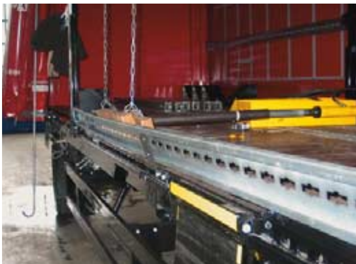
Druck drauf: Durchbiegung bei 10 bar
