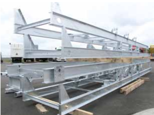
Links altes Chassiskonzept mit Feuerverzinkung, rechts neues Chassiskonzept
