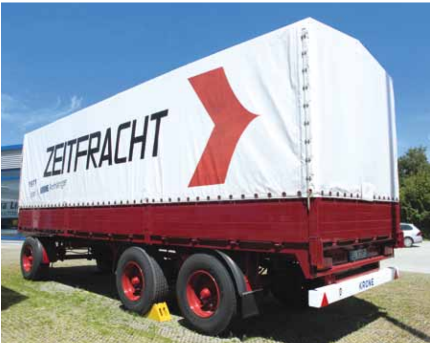
Erster Krone-Dreiaxser überhaupt, für Zeitfracht: Sammelguttransport der 70er Jahre, Zollverschlussplane, Blattfederung, Trommelbremsen
