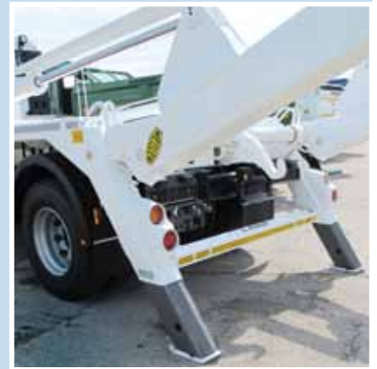
Heckabstützung und Beleuchtungsanlage
