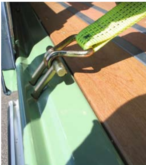
Überprüfung am Pacton vor Ort: Rungentechnik, Zurrwinkel
