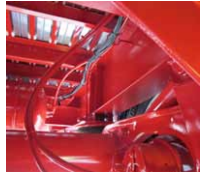
Oben: Pneumatik lackiert, Elektrik nachträglich: nicht mehr Reisch-Standard Nachentriegelung im Heck
