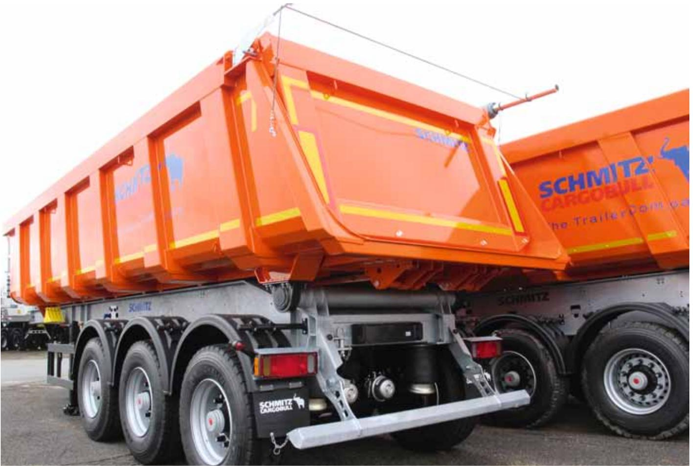
Stahl-Spannenmulde mit 27-t-Aggregat
