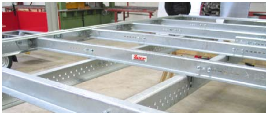
Langlöcher in den Querträgern: Ausgleich für Hauptrahmenbreiten
