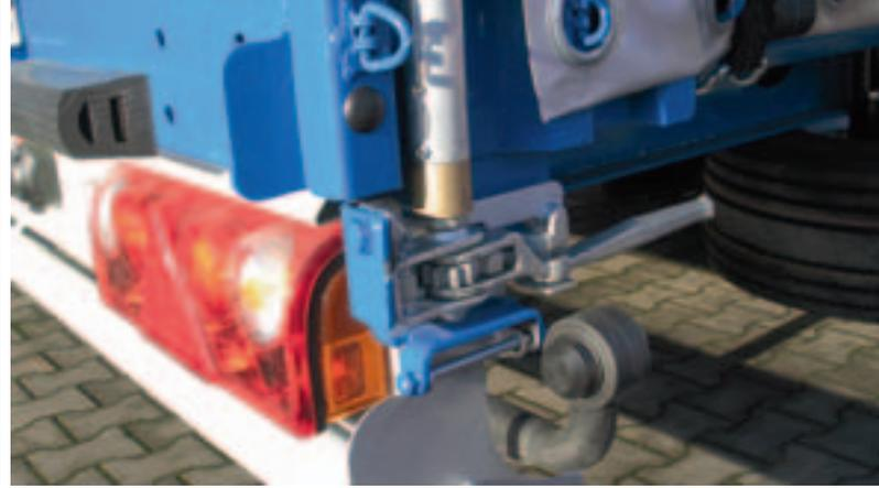
Nicht unkompliziert: Zurrgetriebe mit Zollverschlussverkleidung
