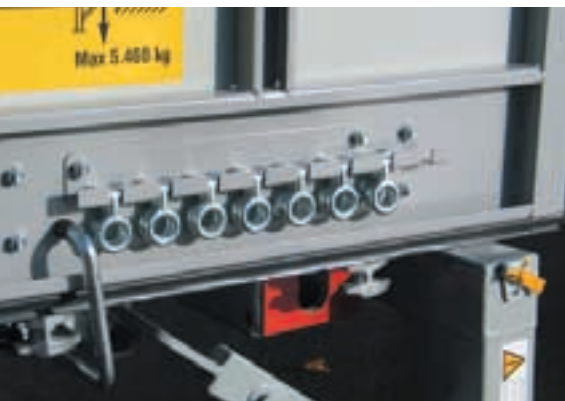
Auch selbst entwickelt: Einsatz-Zurringe (oben) Selbst entwickelt: Stützensicherung (rechts)
