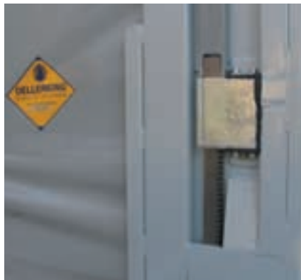
Entwickelt und gebaut: Zahnstangen-Hubmechanik für das Dach
