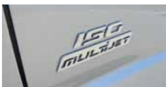
Die Motorbezeichnung 150 Multijet steht für die stärkste Ausgabe des Turbodiesels mit 2,3 l Hubraum.
