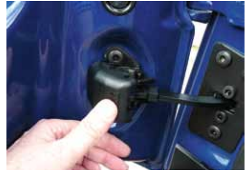
Die Erweiterung der Hecktüren von 90 auf 180° funktioniert anderswo praktischer als mit den sperrigen Drucktasten.
