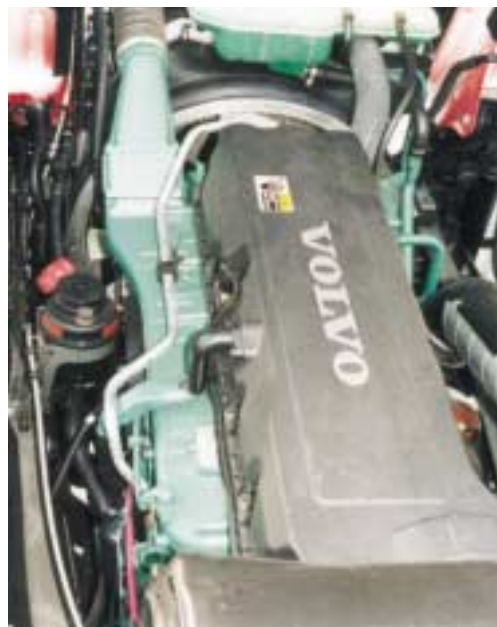
Dreierlei Antrieb: mit Hydraulikpumpe und Antriebswelle für den Kompressor Leicht und kräftig: der 9-l-Motor
