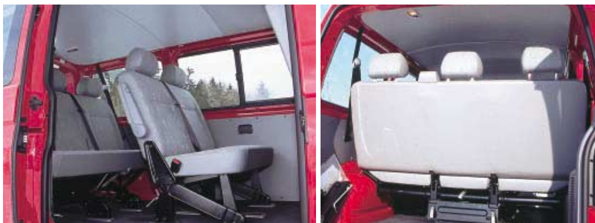
(links) Der Fond ist praktisch-nüchtern gestaltet, die Sitzbänke sind dank reichlich Bodenbefestigungen variabel einsetzbar. (rechts) Der Gepäckraum schluckt eine Menge, doch Vorsicht: Die Nutzlast ist bei 2,8 t Gesamtgewicht eingeschränkt.
